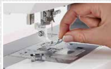
De naaivoet kan eenvoudig worden verwisseld met het klik klaar systeem.
